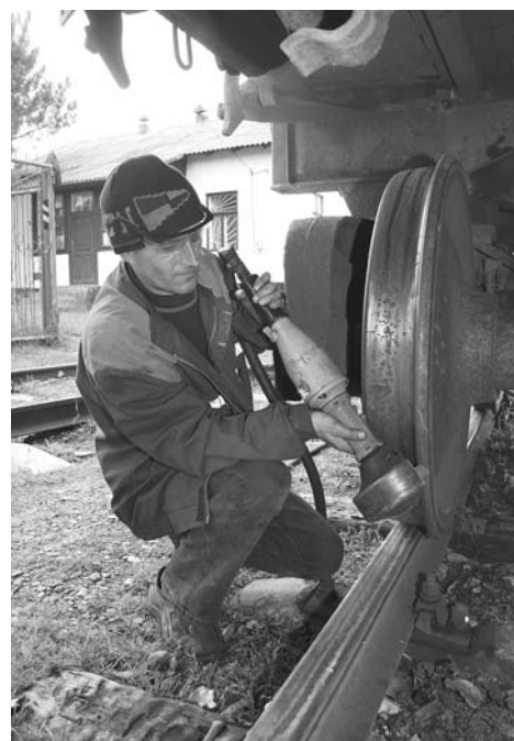
Обточку острого гребня вагонного колеса выполняет слесарь Игорь Дуб.
