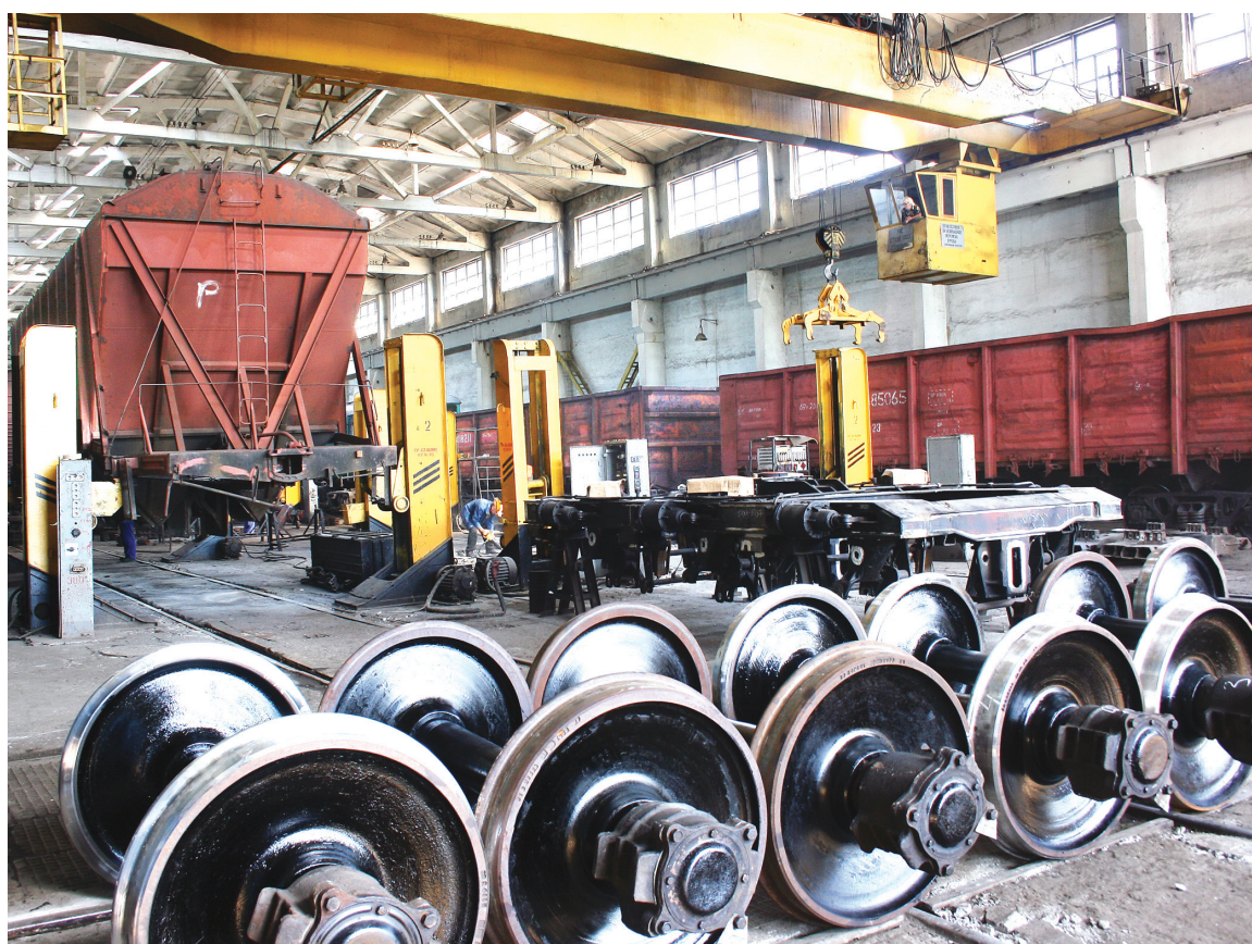
Securitatea circulației depinde în mare parte de starea osiilor montate
